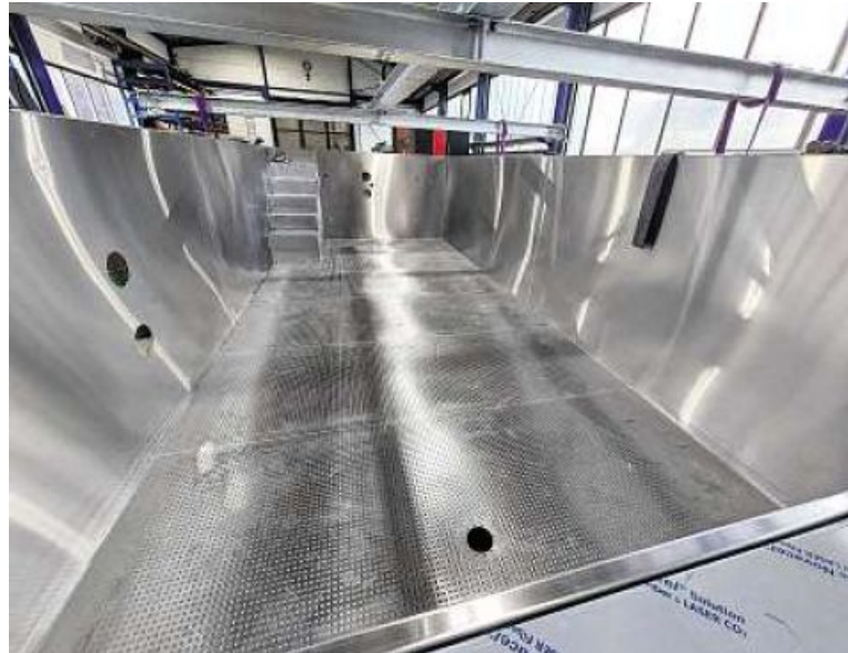
So schaut ein Edelstahlpool aus, wenn er in der Edelstahlwerkhalle in Gemünden steht.
